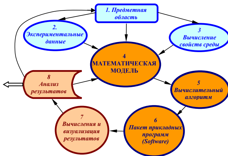
Рис.1 Схема вычислительного эксперимента.
